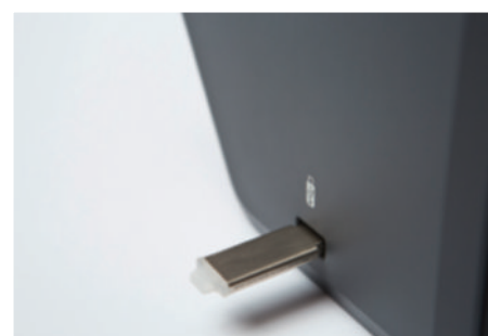
A funcionalidade de digitalizar para USB anfitrião permite-lhe conectar uma memória externa de armazenamento até 64GB, para que os utilizadores possam tornar instantaneamente portáteis os documentos digitalizados.
